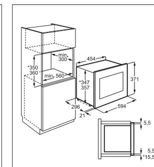
MW17E / MW17EG en armoire haute
